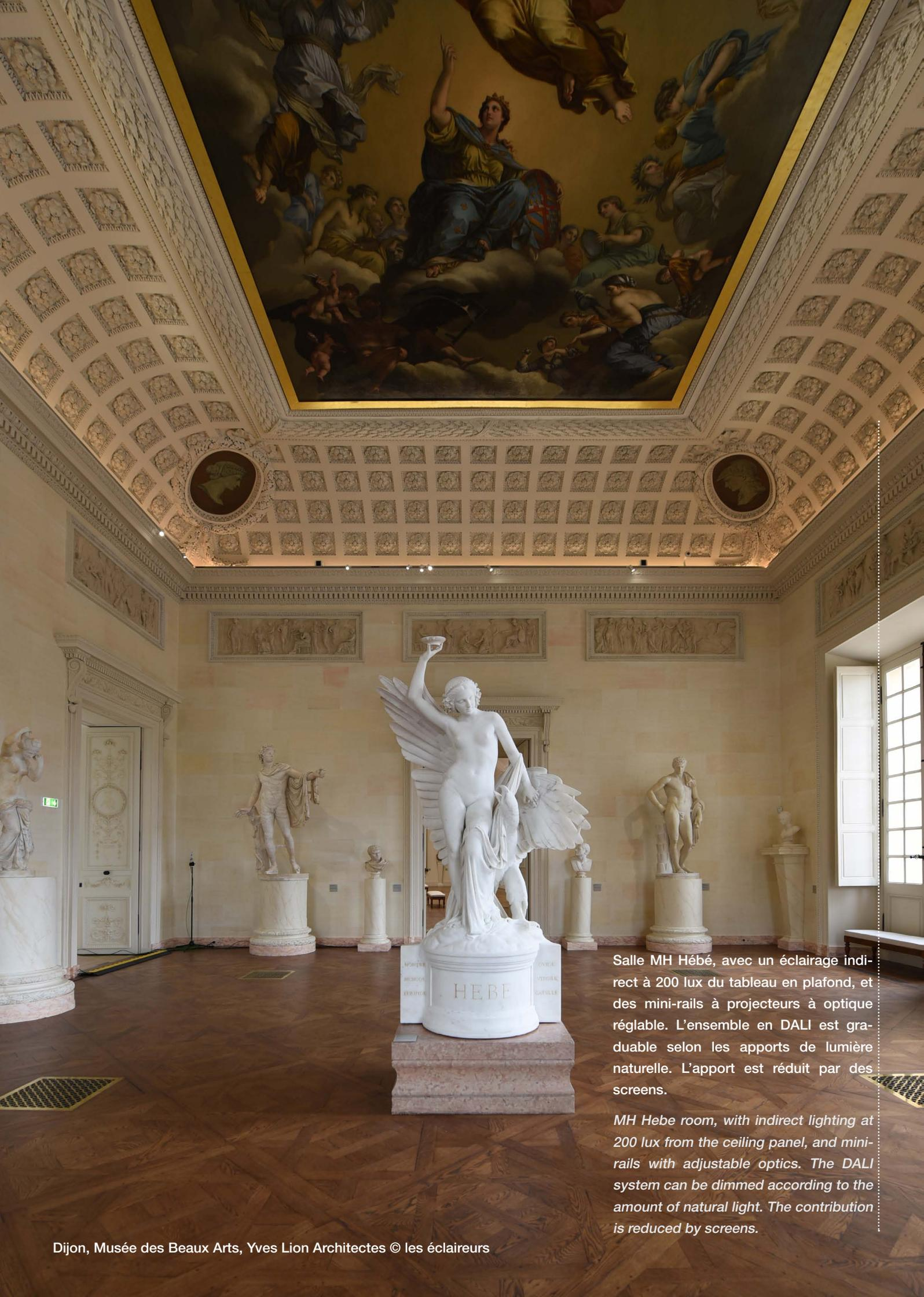
Salle MH Hébé, avec un éclairage indirect à 200 lux du tableau en plafond, et des mini-rails à projecteurs à optique réglable. L'ensemble en DALI est graduable selon les apports de lumière naturelle. L'apport est réduit par des screens.
